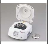
死体から採取した血液に強大な遠心力 をかけることによって、血清とそれ以外の 成分とに分離する装置。
