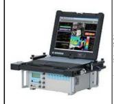
交通事故における、車両の変形状況、運行記録計の精密解析、車両制御ユニットからのデータ抽出、労災事故における、機械・構造物の力学解析、劣化状況、殺人・傷害事件における、凶器の打撃力等の測定を行う装置。
