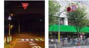
道路標識の高輝度化・大型化
