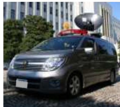
応急通信対策車
