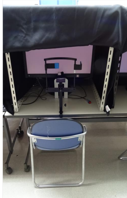
＜本検査で構成した新たな視野検査機器（平和橋自動車教習所）＞
