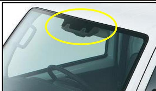
◆障害物検知機能付ペダル踏み間違い急発進抑制装置 (PMPD)
