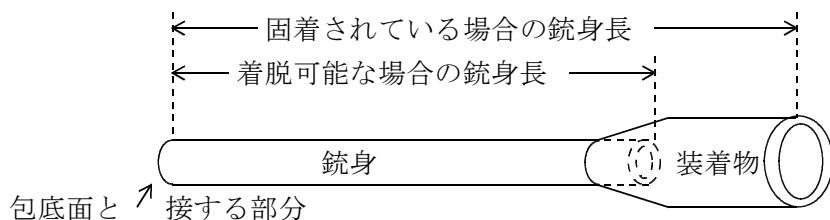
**注2** 包底面とは、薬室閉鎖位置にある遊底の薬莢底面と接する面をいう（写真4～9参照）。
