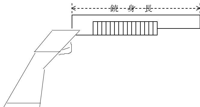
(イ) 単身自動式、単身ボルト式、単身レバー式、単身スライド式（ポンプ式）にあっては、薬室を閉鎖した状態で、銃口から腔旋を傷つけない材質の棒（プラスチック性又は樹脂コーティングをした洗い矢（銃身の清掃用具）等）を包底面に当たるまで挿入し、銃身内に潜った深さを測定する（写真12・13参照）。
