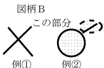
充分な太さを持たない線等で構成された図柄(例①)や図柄の一部(例②)は、図柄として識別できないものである。
