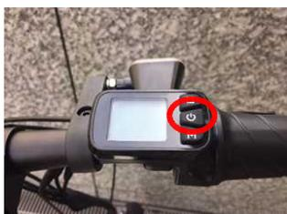
ウ 左右のスイッチを同時に押下して「モビチェン」機構を作動させ、人力モードに切り替える
