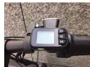
手元のスイッチ (原動機の電源が入っておらず、 スイッチを押下しても電源が 入らない)
