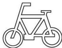
図 II-2 規制標示「特例特定小型原動機付自転車・普通自転車歩道通行可（114 の 2）」
