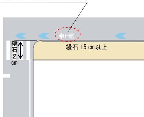
図 II-75 交差点隅角部の道路構造の例（車道混在の場合）
