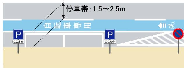
図II-40 自転車専用通行帯と停車帯を設置する例
