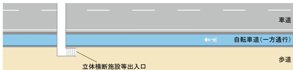
図 II-33 車道空間を縮小して自転車道を設置、
