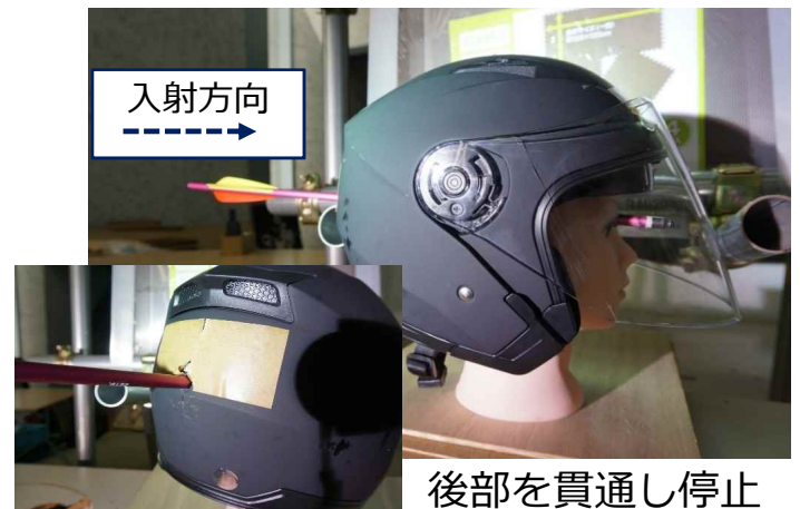
科学警察研究所における実験 (合成樹脂製ヘルメットに対する射撃実験)
