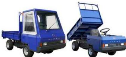
ホイール・キャリヤは、工事現場、農地等の場所において、土砂、農産物等の運搬作業を行うために使用されている。
