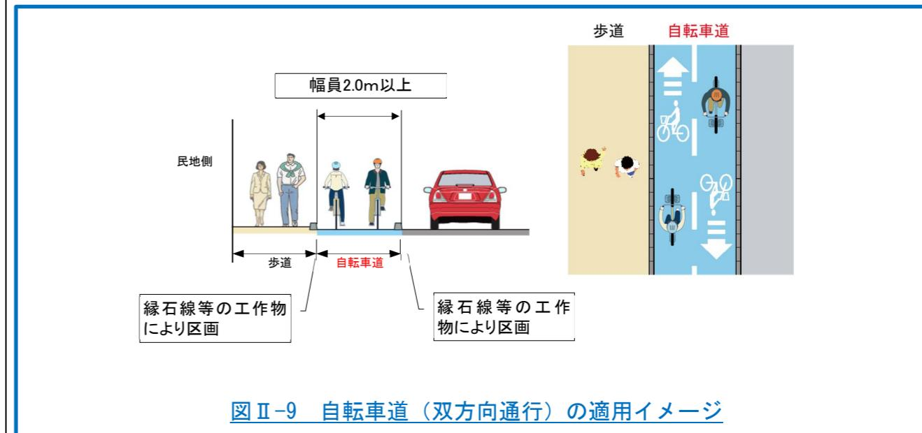
図 II-9 自転車道(双方向通行)の適用イメージ
