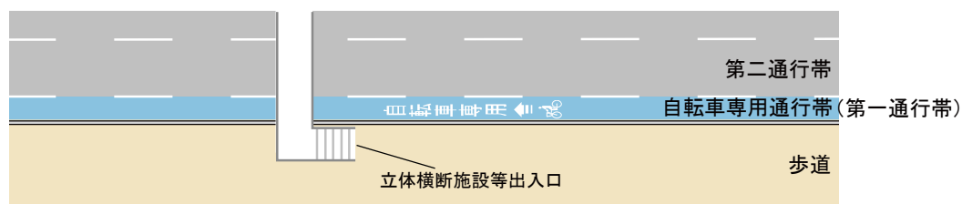
図Ⅱ-37 立体横断施設等出入口付近で自転車専用通行帯を設ける例
