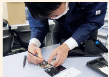
スマートフォンの解析 (機器の分解・洗浄)
