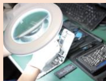
スマートフォンの解析 (機器の分解・洗浄)
