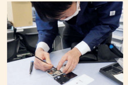
スマートフォンの解析（機器の分解・洗浄）
