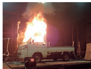
火災の再現実験の様子
