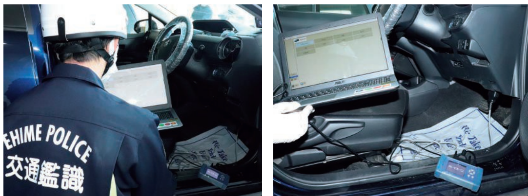
車載式故障診断装置用スキャンツールによる情報読み取り状況
