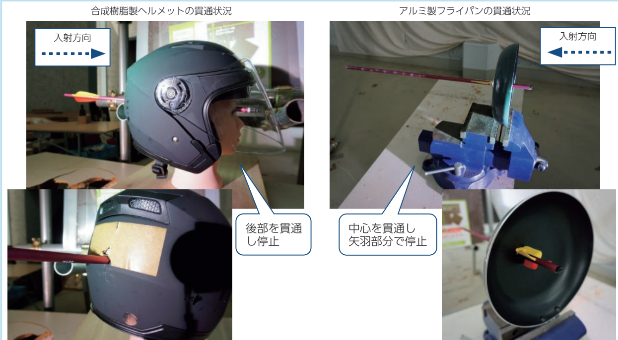
図表特4-3 物品に対する射撃実験
