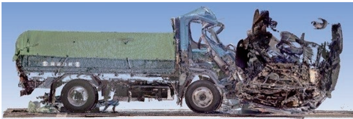
3Dレーザースキャナによる三次元画像
