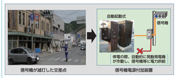
図表特1-2 信号機電源付加装置のイメージ
