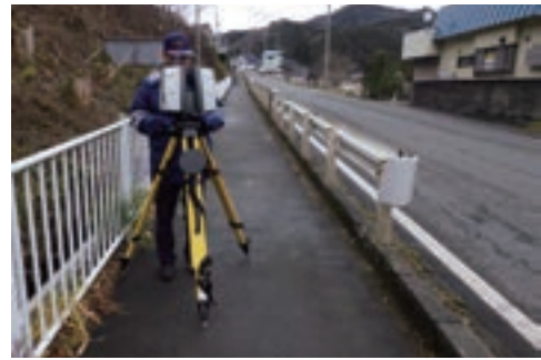
3Dレーザースキャナによる測定状況
