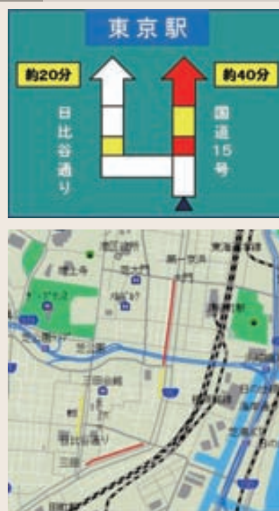
図 3-17 VICS対応型カーナビゲーション装置の画面表示例
