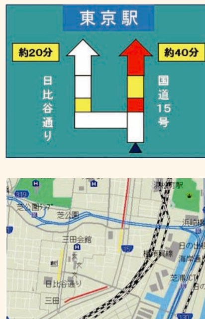
図 3-19 VICS対応型カーナビゲーション装置の画面表示例
