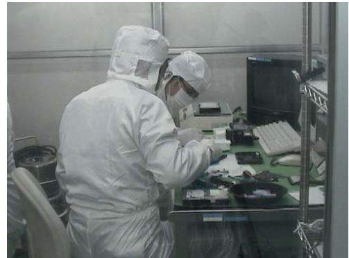
クリーンルームにおける ハードディスク部品の移植作業
