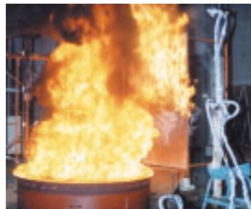
隣接建物壁への延焼実験（研究例2）
