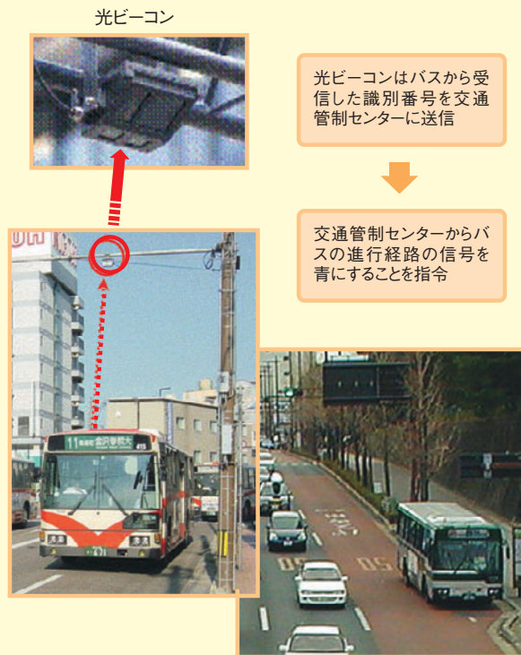
● 図6-17 ● 公共車両優先システムの概略図 ●
