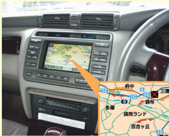
● 図6-19 ● VICS対応型カーナビゲーション装置とその画面表示 ●
