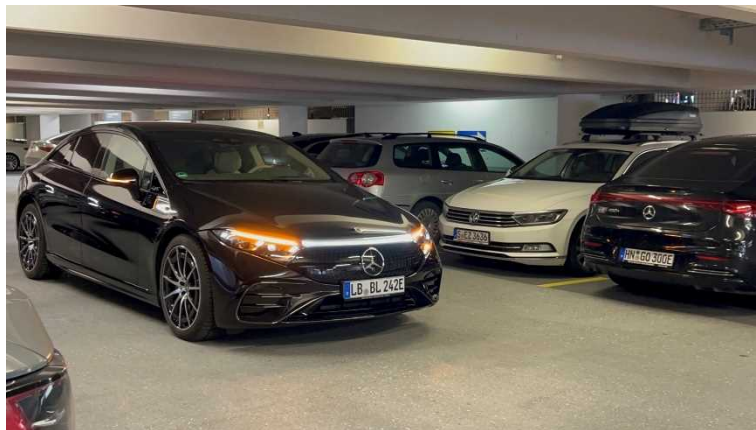
図 14 接続状態が不安定なことによりハザードランプを出して停車する様子
