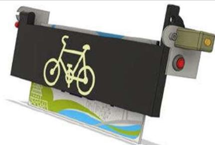
自転車モード：カバーが閉じていて（ナンバープレートが見えない）、通電しない
