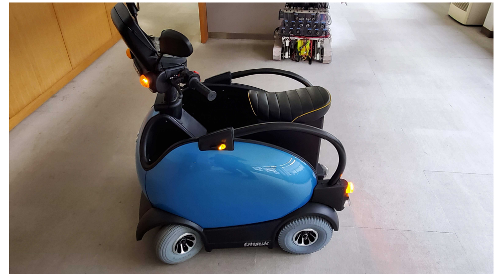
ミニカーモード: 最高速度12km/h(ライト点灯)
