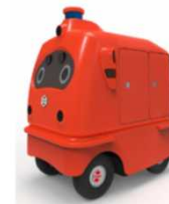
自動配送ロボット (最高速度: 6km/h)
