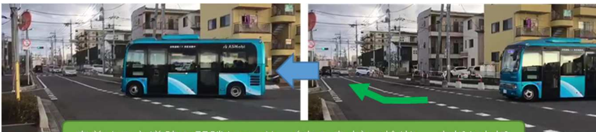
交差する主道路の間隙をセンサー(右の赤丸)で検出し、右折を支援
