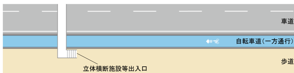
図Ⅱ-33 車道空間を縮小して自転車道を設置、 又は新設道路に自転車道を設置する例
