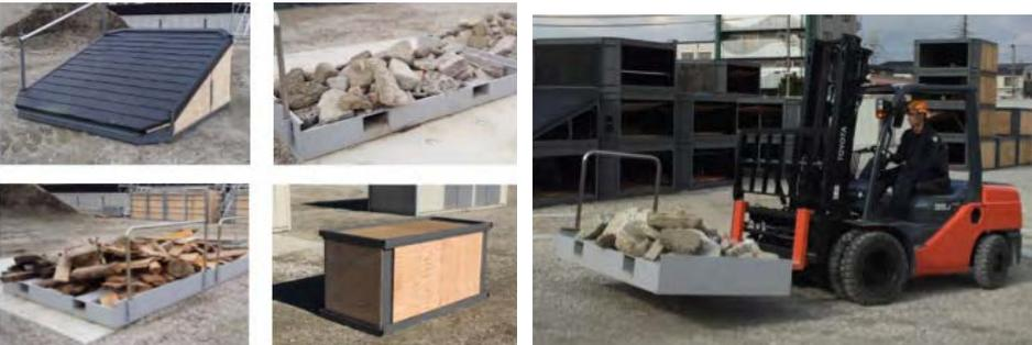
＜災害現場への類似性を重視した従来の模擬現場型の訓練施設とくらべ、訓練対象部隊や訓練内容に応じて組み替えられ、訓練の事前事後は設定・撤収が容易、訓練中は指導や安全管理が可能、また維持管理面も優れた「管理型」訓練施設（訓練中はもちろん、設定・設置、撤収、管理・維持の安全な運用を最重要視。ハード的に二重、三重に安全配慮を施した詳細設計および運用手順策定も含めた総合デザインによる安全設計＞
