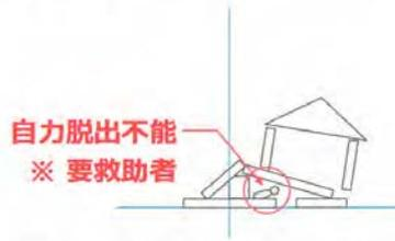
木造軸組み工法2階建て（1階部分崩壊の場合）
