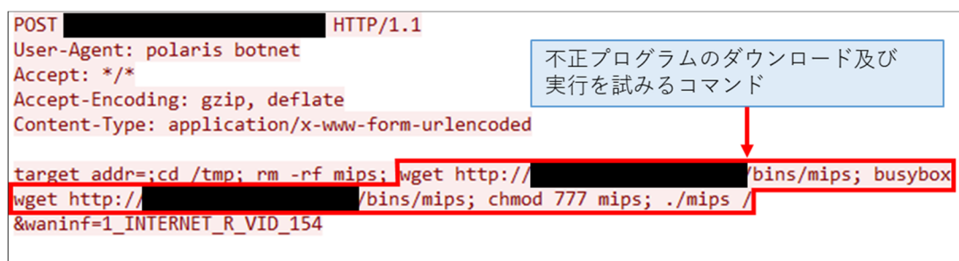
図8 インド製 GPON ルータの脆弱性を悪用したアクセスの例(一部マスキングを実施)
