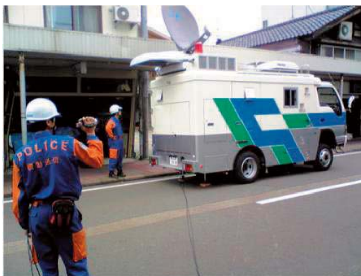
機動警察通信隊が撮影した映像を伝送する衛星通信車（新潟県柏崎市）
