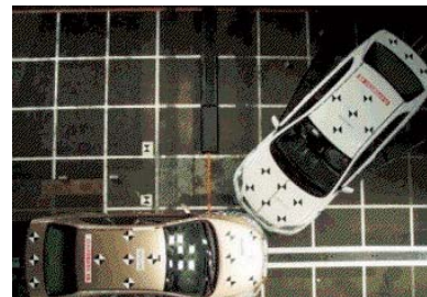
精度・信頼性検証のための実車衝突実験
