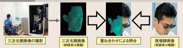
図1-29 三次元顔画像識別システムによる顔画像照合
